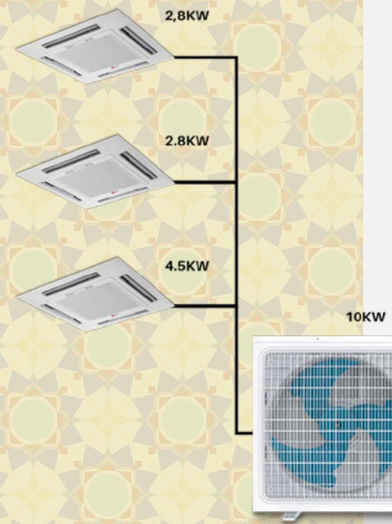
3 pièces à chauffer/refroidire en utilisant des cassettes de puissance de : une de 4.5 KW et deux de 2.8 KW en utilisant un même moteur de 10KW.
